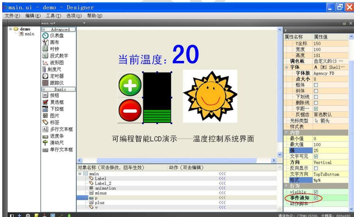
12) 选中按钮 plus，点击属性区中的“**动作脚本(action)**”属性按钮，进入脚本编辑界面，在“**触发条件**”中选择“**pressed**”，在输入框中输入如下 JavaScript 脚本程序：
