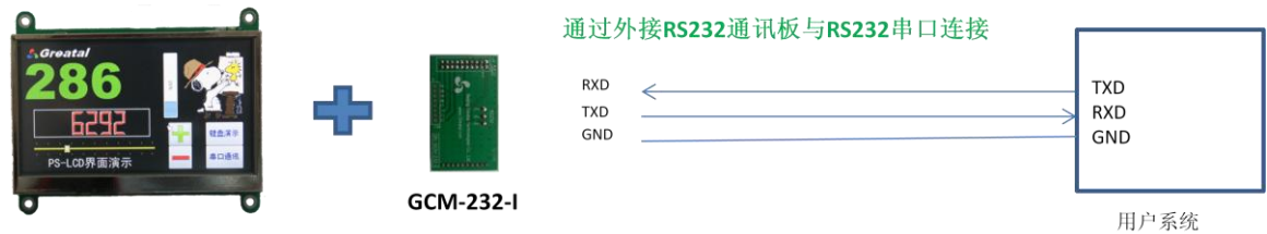
PS-LCD与用户系统RS232串口连接图
