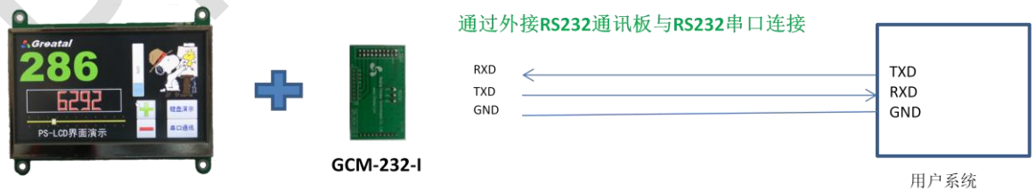
PS-LCD与用户系统RS232串口连接图
